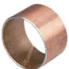
CNB-MT-2又叫JF720双金属轴承,是以钢板为基体,表面烧结CuPb24Sn4 材料的产品。该产品具有较好的疲劳强度和承载能力。适用于中速中载,有油润滑的场合表面镀软合金时,可用作高速内燃机轴承、连杆衬套,达到良好的耐磨、耐疲劳效果。
