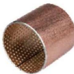
CNB-MT-1又叫JF-800双金属轴承,是以低碳钢板为基体材料,表面烧结了CuPb10Sn10 或者 CuSn6Zn6Pb3 材料的钢铜合金产品。该产品是双合金轴承中承载能力最强的一种,重型车的平衡桥衬套,均使用该产品。它是一种用途很广的高载低速运动轴承。
