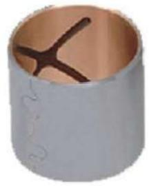
CNB-MT-3又叫JF-700双金属轴承,是以钢板为基体,表面烧结CuPb30 材料的产品。该产品由于含铅量高,所以具有良好的抗咬合性和异物埋没性。工作表面需镀软合金材料,可用作高速、中低载的内燃机主轴瓦、连杆衬套、摇臂衬套;油泵侧摩擦片。
