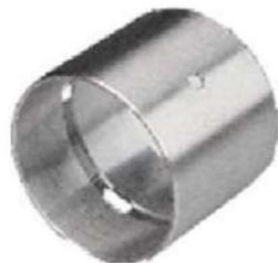
CNB-MT4又叫JF-20高锡铝基轴承,是以钢板为基体,表面辗压AlSn20Cu材料的产品。该产品具有中等疲劳强度和承载能力,良好抗腐蚀性能,较好的轴承滑动性能等特点,常用作中小功率的内燃机轴瓦、火车发动机轴瓦、空气压缩机轴套、制冷机轴承,是取代巴氏合金的新颖产品。
